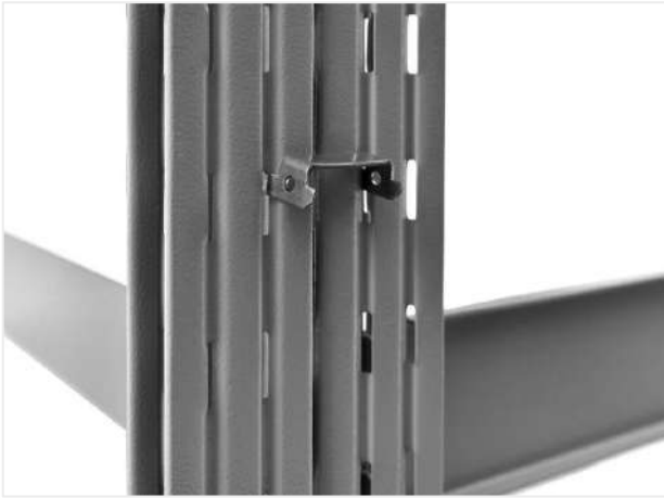
43 Устанавливаем соединительную скобу ТСУ в две стойки (при креплении спина к спине), как показано на фото.
